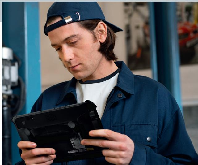
**Caratteristiche del tablet:** Resistenza a polvere e acqua (IP65) / Resistenza alle cadute da un massimo di 1.2 m / Memoria 8 GB / Display 1200 x 1920 / Completo di magneti / Peso inferiore a 800 g / WLAN IEEE 802.11 ax+r/k/v WiFi6E, WiDi, WWAN, BT5.3, BLE
