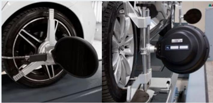
I target Real 3D installati sulle griffe sono estremamente leggeri, esenti da manutenzione e senza componenti elettronici. I target Real 3D consentono di saltare la procedura di Run out, velocizzando l'attività dell'operatore e massimizzando l'efficienza dell'officina.
