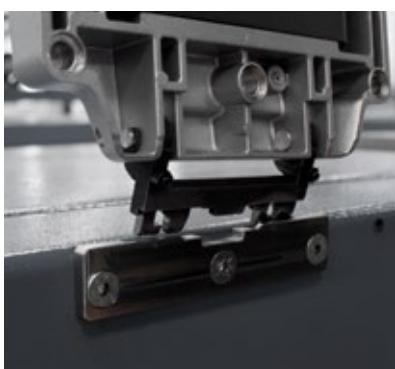
Le teste di misura 3D si agganciano al ponte sollevatore in pochi secondi tramite un sistema pivotante.
