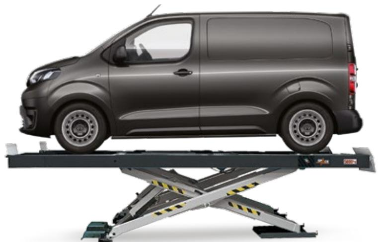
Ponti sollevatori per misurazione assetto ruote.
